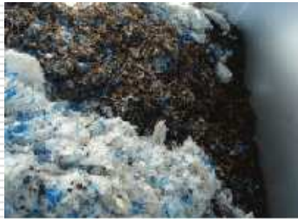
フラフ燃料と汚泥
